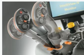
Le mouvement par impulsions permet à l'opérateur de faire varier sa vitesse et de changer de direction.
