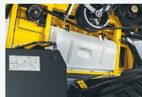
Les couvercles d'accès aux rotors en matière plastique, peuvent être déposés sans outil.
