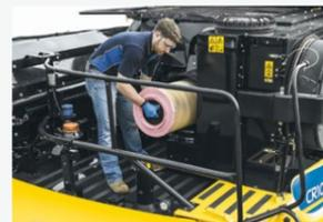
Le filtre à air du moteur est accessible depuis la plate-forme du compartiment moteur.
