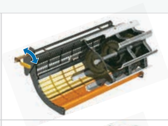
Battitore standard e sezione per granella piccola
