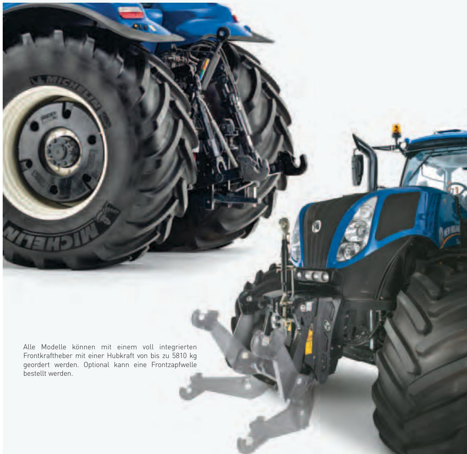
Alle Modelle können mit einem voll integrierten Frontkraftheber mit einer Hubkraft von bis zu 5810 kg geordert werden. Optional kann eine Frontzapfwelle bestellt werden.
