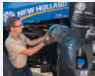
Der Luftfilter kann ohne Aufstellen der Motorhaube kontrolliert, gereinigt und ausgetauscht werden.
