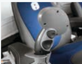
Umschalttaste und Entsperrung des Fahrhebels (hinten).
