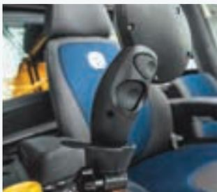
Umschalttaste und Entsperrung des Fahrhebels (hinten).
