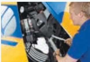
Die einteilige, superbreite Fronthaube erlaubt einen einfachen Zugang zu allen beweglichen Teilen sowie zu Öl- und Schmierelementen.
