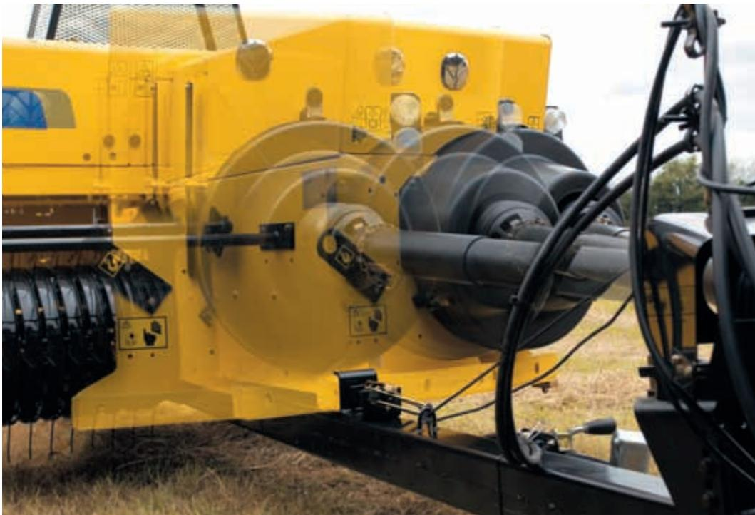
Eine zügige und sichere Umstellung von Straßen- auf Arbeitsstellung ist mit der „Hydro-Swing“-Deichsel möglich. Sie nutzt die Traktorhydraulik und macht das Umstellen zu einem schnellen und einfachen Vorgang.
