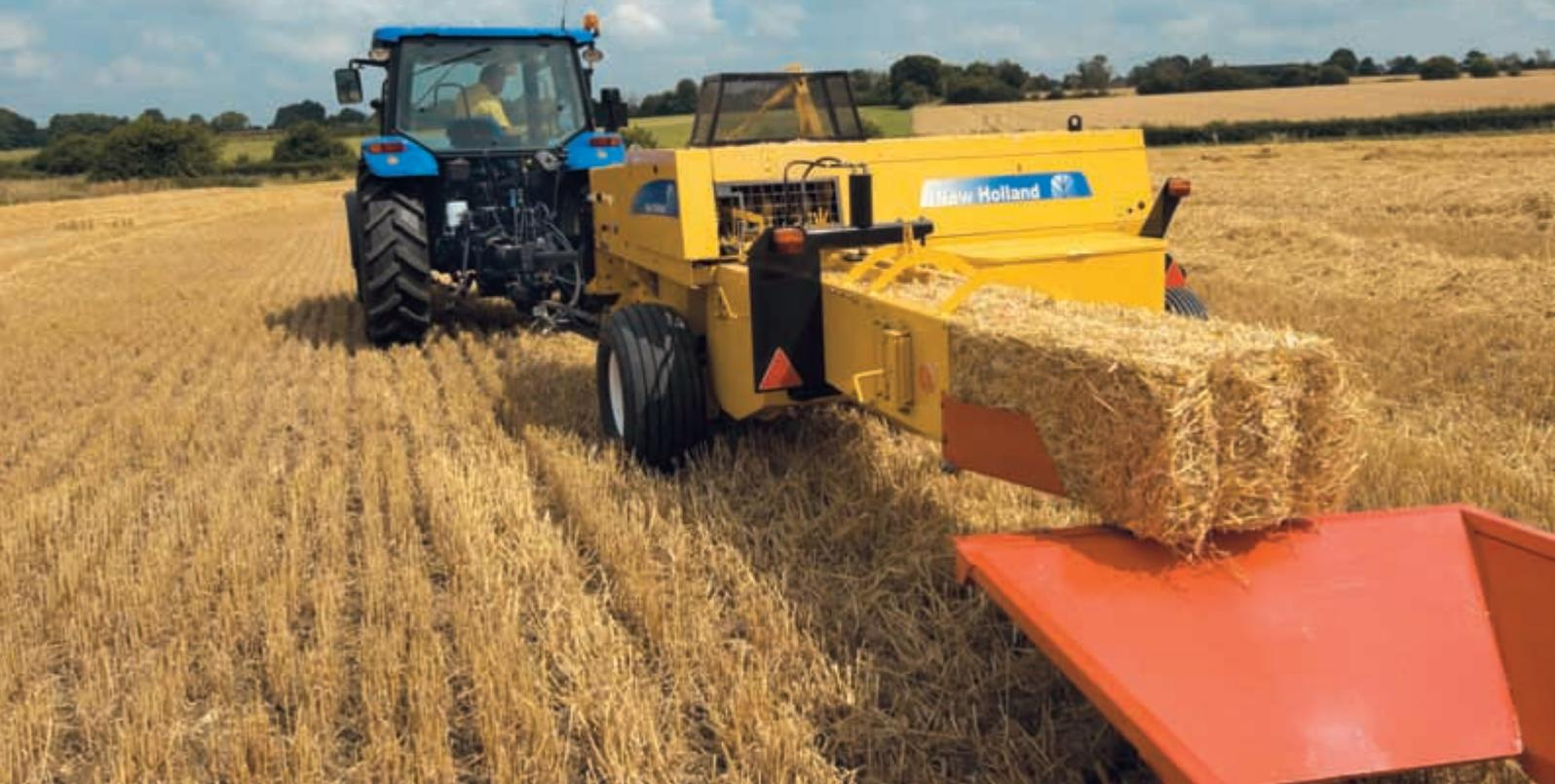
Das Pressen fester und stabiler Ballen gehört zu den Hauptstärken der neuen BC5000-Modelle. Die lange Ballenkammer, die einen größeren Kolbenhub ermöglicht, gewährleistet zusammen mit der hohen Kolbengeschwindigkeit eine erstklassige Ballenformung. Verstellbare obere und untere Pressschienen sowie verstellbare Pressklappen sorgen für eine perfekte Pressdichteeinstellung.
