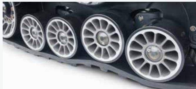
Deux paires de galets à suspension hydraulique agissent indépendamment pour offrir une conduite en douceur et sans à coup. Les déplacements routiers sont encore plus sûrs avec ces galets oscillants qui épousent parfaitement les ondulations de la route. Une plus grande longueur de chenilles procure une plus grande empreinte au sol et un tassement réduit.
