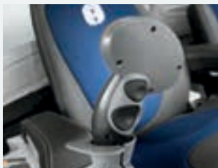
Déverrouillage de la vitesse d'avancement (Derrière).
